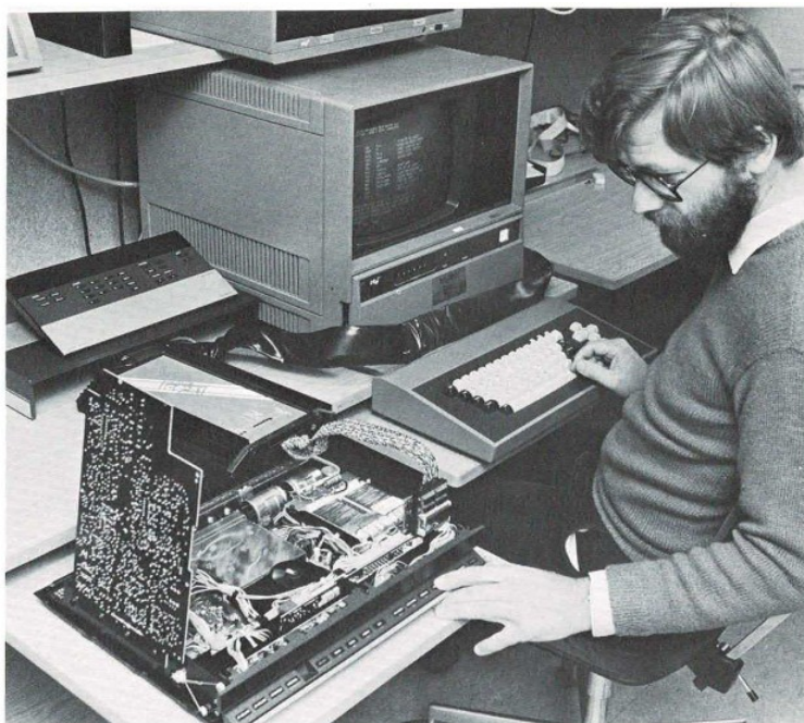
Ingeniør Arne Rohde arbejder med programmeringen af mikrocomputeren i Beomaster 5000. På B&O designer vi selv en mikroprocessor prototype, som vi derefter får produceret eksternt. V.h.j.a. den navlestreng som forbinder Beomasteren med Arne Rohdes computer kan han kontrollere, hvad der sker i BM 5000's 'hjerne'.
