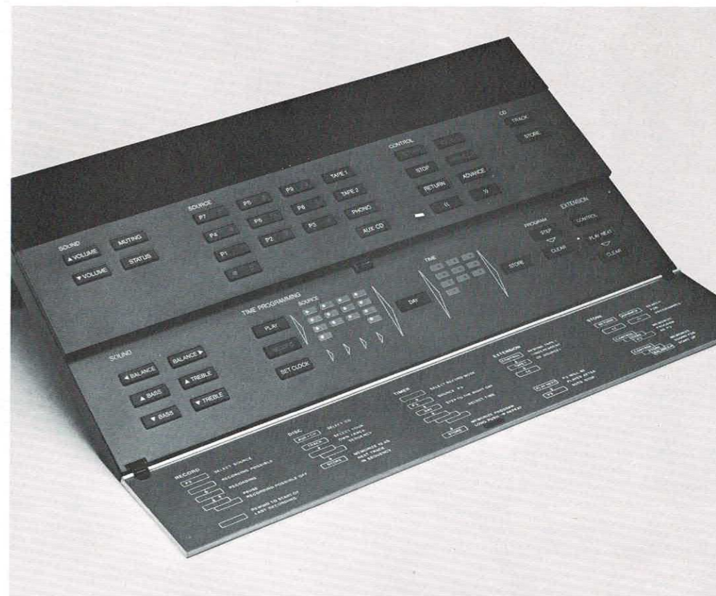
Master Control Panelet som kan styre alle funktionerne i B&O's nye hi-fi system ved en tovejskommunikation med infrarøde stråler.
