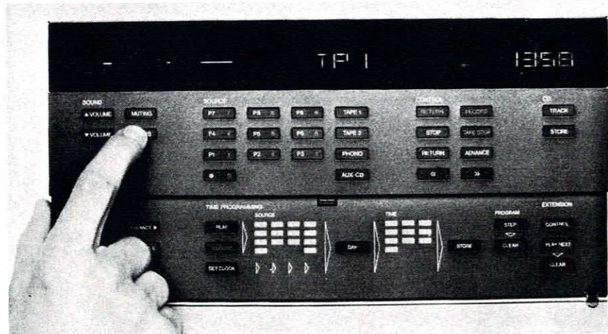
"Status" knappen kalder en masse oplysninger frem, — fra venstre: Volumen, balance, tone, signalkilde, dag og tidspunkt. Nederst ses, hvordan timerne kan programmeres.
