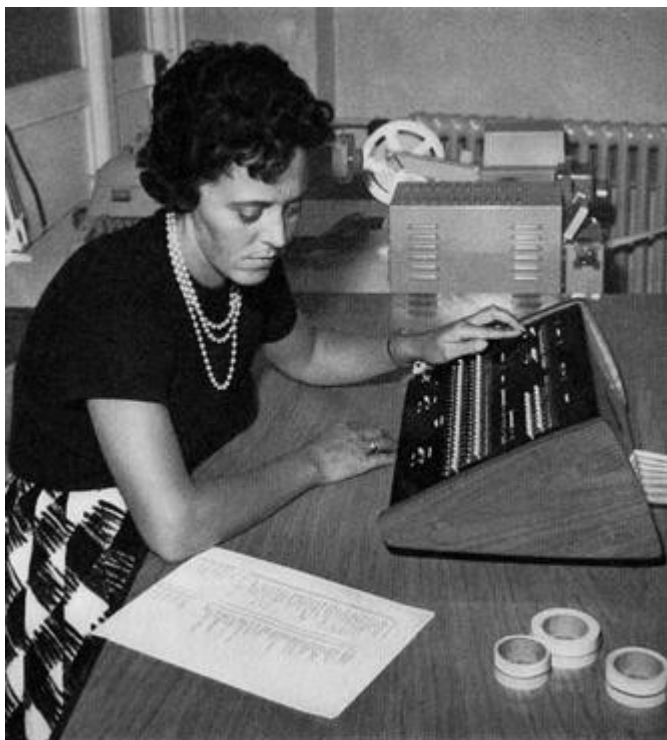
EDB-anlæggets kontrolpult er ikke større end en almindelig bordregnemaskine, og dog styrer den et anlæg, der afvikler fra et halvt til 10 mandårs beregnings- eller administrationsarbejde pr. time.
