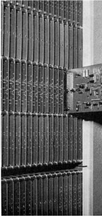
Transistorer og trykte kredsløb betinger et meget kompakt og meget hurtigt anlæg.
