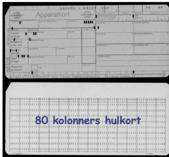
Fig. 4: Moderne hulkort havde 80 kolonner
