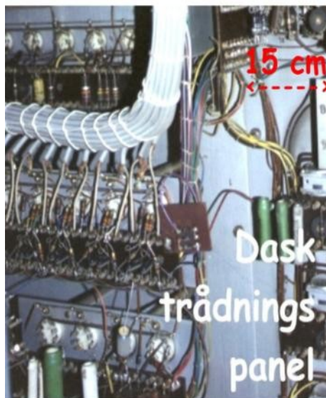
Fig. 10. Dask's elektronrør sad på aluminiumsplader med ledningerne på bagsiden
