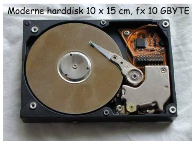
Fig. 24. Moderne harddiske er meget mindre og rummer kolossale datamængder
