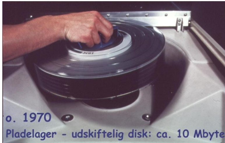
Fig. 23. Hard-disk'en var i starten stor og tung, og kunne udskiftes ligesom magnetbånd.
