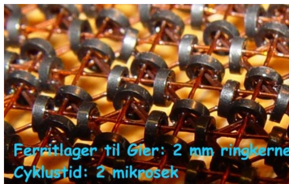
Fig. 21. Også Gier havde flere typer magnetiske lagre. RAM-lageret var med Ferritkerner.
