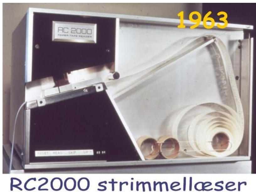
Fig. 28. Den danskproducerede RC2000 strimmellæser blev solgt over hele verden.
