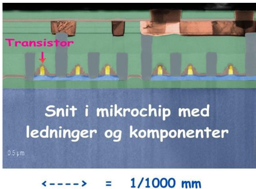
Fig. 8. Kun i mikroskop kan man se komponenter og ledninger
