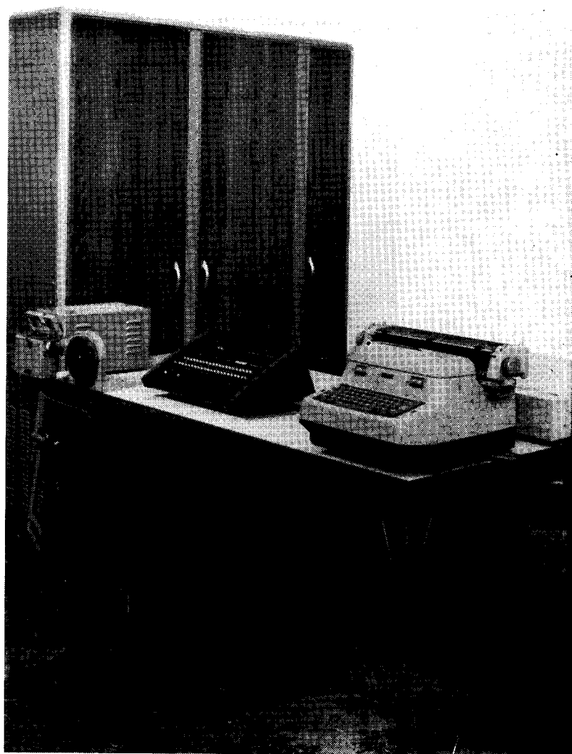
Centralenheden af GIER indeholdes i skabet i baggrunden. På bordet står til venstre en læser for papirbånd, i midten selve manøvrepanelet og til højre en skrivemaskine for ind- og udlæsning og bag skrivemaskinen en hurtig perforator til udlæsning.
