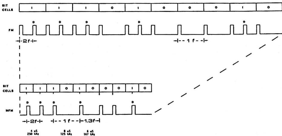
Disse ændringer kan registreres, som et frekvensskift mellem (i dette tilfælde) en grundfrekvens (1f) og en dobbelt så høj frekvens (2f).\*)
