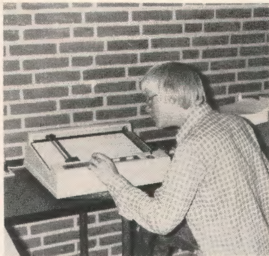
Vingeprofiler til vindmølle II udtegnes på plotteren (RC 7000/Textronix).
