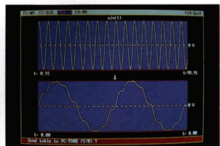
10. Når to sinustoner adderes med forskellige amplituder dannes en kurve, som i den nederste rude. Signalet sendes nu til PC-TONE.
