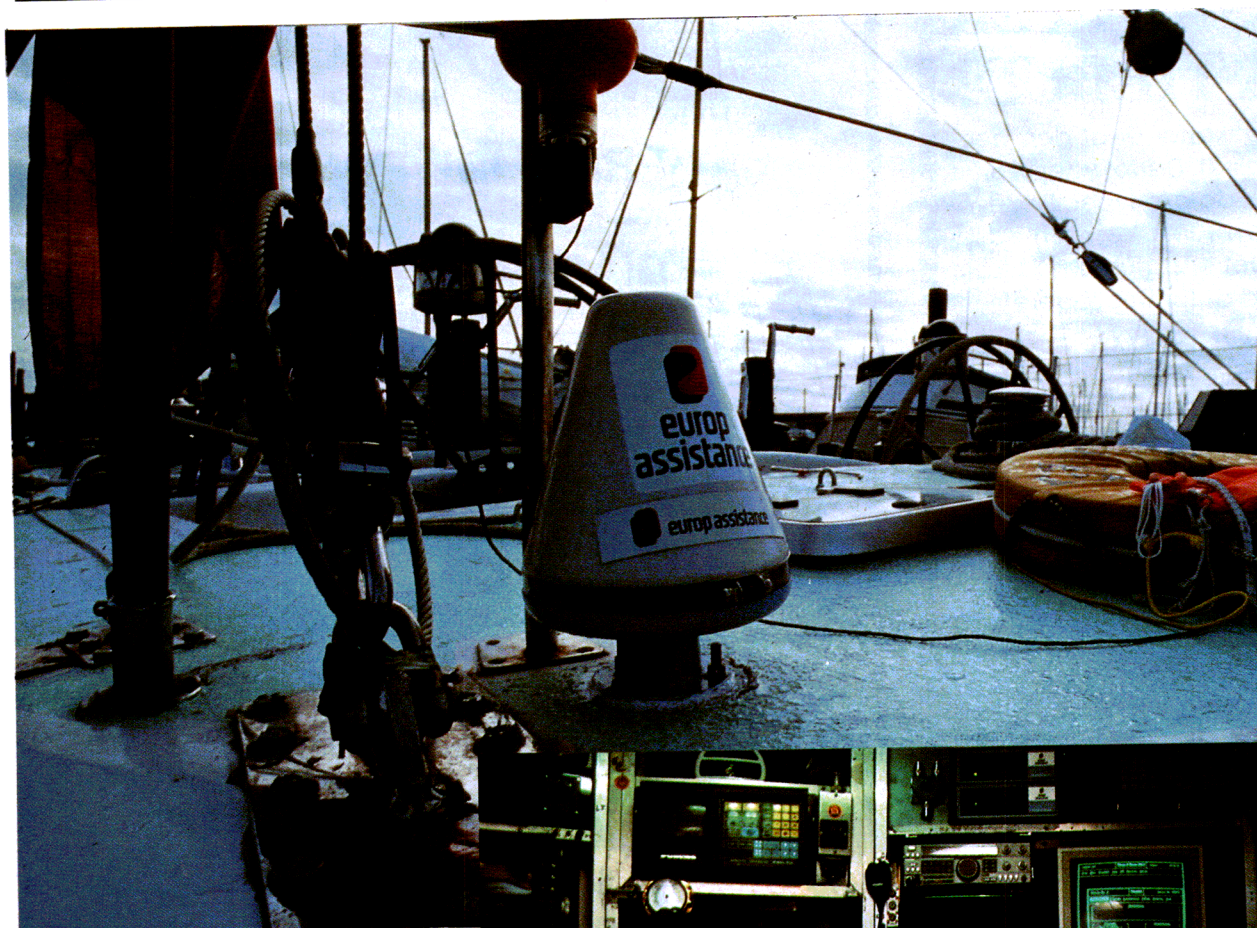
Satellit transceiveren er forsynet med SOS-funktion, som kan aktiveres direkte på terminalen.
