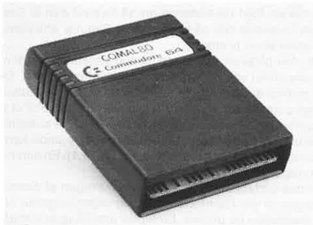
Figur 1.4: COMAL 80 kapslen forøger Commodore 64's styrke uden at optage yderligere lagerplads. Kapslen passer ind i stikket på bagsiden af Commodore 64 (På SX-64 er kapselstikket anbragt på oversiden).
