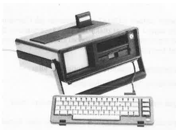
Figur 1.2: Den transportable Commodore SX-64 computer er kompatibel med Commodore 64. Den har sin egen indbyggede monitor og diskettestation men ingen Datassette grænseflade.
