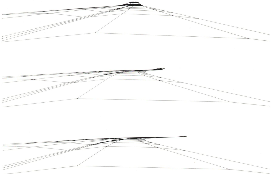
Perspektiviske billeder af en vej på projekteringsstadiet under et gennemløb på 1200 m.
