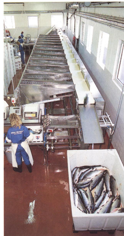
Automatisk sortering og pakning af hele laks på et Scanvægt-anlæg
