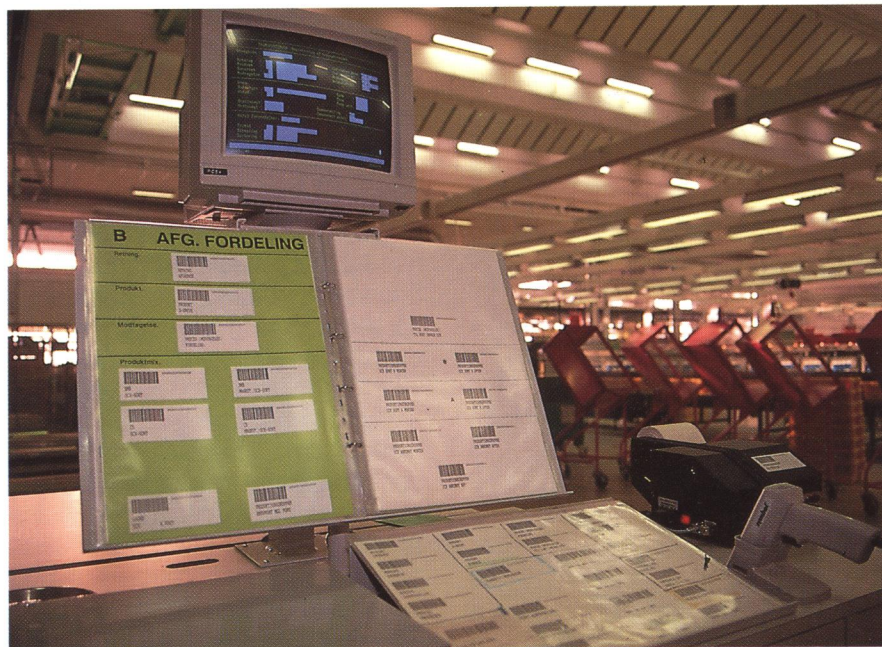
'CenterDriftsStyring-systemet' i Københavns Postcenter. Her registreres postmængden ved hjælp af laserpistol, PC og Supermax
