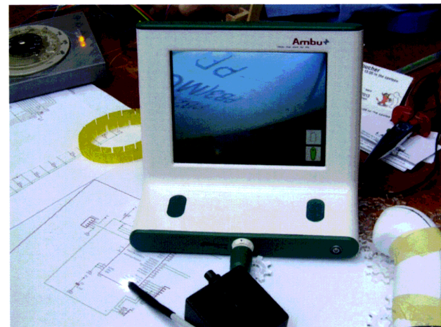
Det viste endoskop er ikke en vanvittig kostbar ting og er meget nyttigt til både inspektion af vanskeligt tilgængelige steder og meget andet. Man bliver informeret om at det altså ikke er nødvendigt med den lidt specielle skærm - man kan bruge en almindelig PC.
