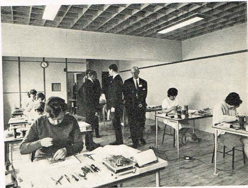
på skolebænken, inden de eventuelt indsættes på produktionsbåndene. Foruden i lodning underviser skolen også i montage (komponentlære), kvalitetskontrol, arbejdsstudie og arbejdsfysiologi.
