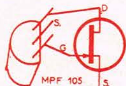
Skitse som viser forbindelserne til transistoren MPF105 (Field Effect).
