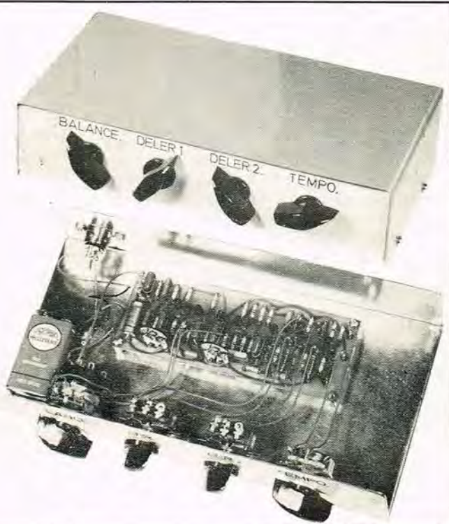
Herover monteringsplan for printet og i øvrigt 3 billeder, der skal være rigelig vejledning i, hvordan man bygger rytmeboksen op — rent mekanisk.
