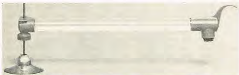
Her er Lenco's vædskefyldte tonearm, der trækker et 10 mm bredt spor foran pick up'en. Overfladestøjen mindskes, fordi støvet borstes væk samtidig med at pladen aflades for statisk el.
