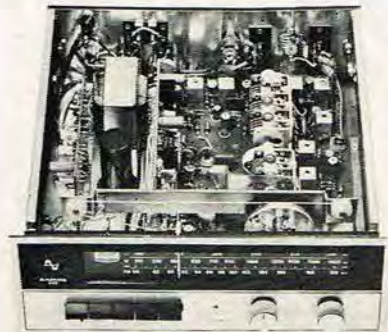
Forstærkerdelen har servicevenlige moduler.
