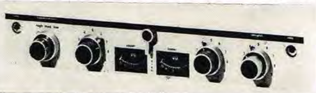
Forstærkerpanelet med dobbeltknapperne for indspilning og afspilning samt de to VU-metre med kanalvælgerknappen.
