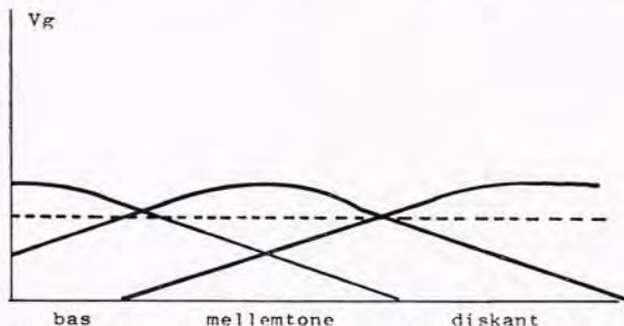
TIL HØJRE ses fig. 2, der illustrere dæmpning pr. oktav. HEROVER fig. 3. Den punkterede streg angiver tændspændingen.
