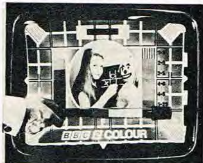
Gråtoneskalaen kontrolleres med referencerør.
