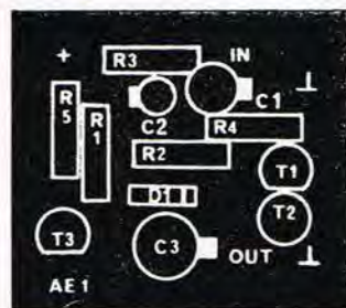
... og her den modsatte side af printpladen med komponentplaceringen indtegnet.
