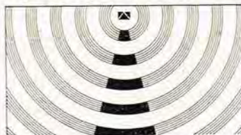
Et normalt højttalersystem udstråler retningbetonet.
