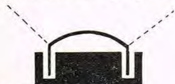
Fig. 6. Princippet for Dome-højttaleren.
