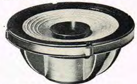
Fig. 5. Diskantspreder påmonteret svingspolen.
