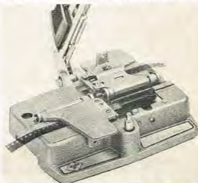
Kilesplejseren er justeret, så den skraber af emulsionen af den ene filmende og samtidig giver de to filmender, som skal splejses sammen, et skråt snit. Det gør splejsestedet så tyndt (men stærkt nok), at det ikke klikker i gengiverens filmkanal.
