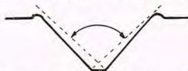
Fig. 7. Den kegleformede membrans spredning.
