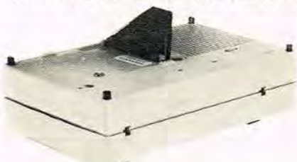
PAS PÅ INSTRUMENTET: Et »Normatest« lagt på glasset, i almindelighed ingen heldig position — her for at vise, hvorledes et moderne instrument ved sit støtteben kan placeres i praktisk skrå arbejdsstilling.
