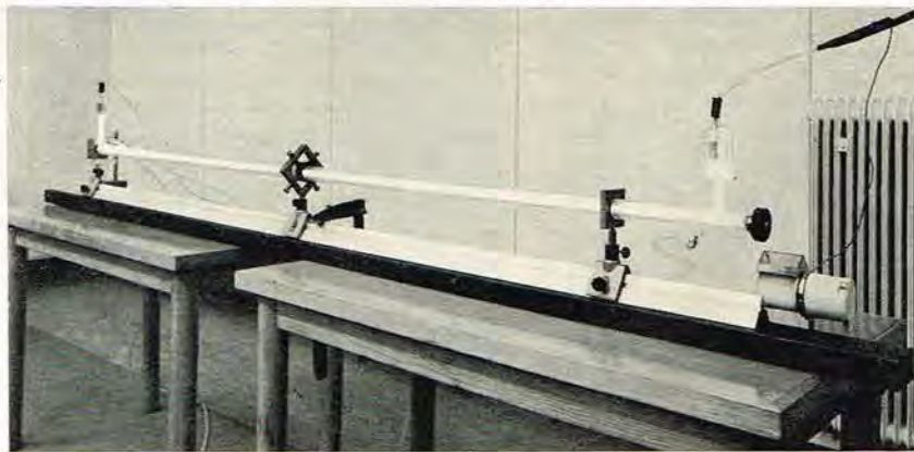
Fig. 1 viser en typisk laboratorieopstilling, en vandkølet gaslaser af kuldioxyd-typen.
