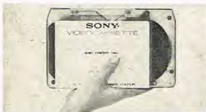
Herover en af de egentlige kassetter, japanske Sony, hvor både lyd og billedinformationer er optegnet ad magnetisk vej, ganske tilsvarende enhver normal båndoptager.
