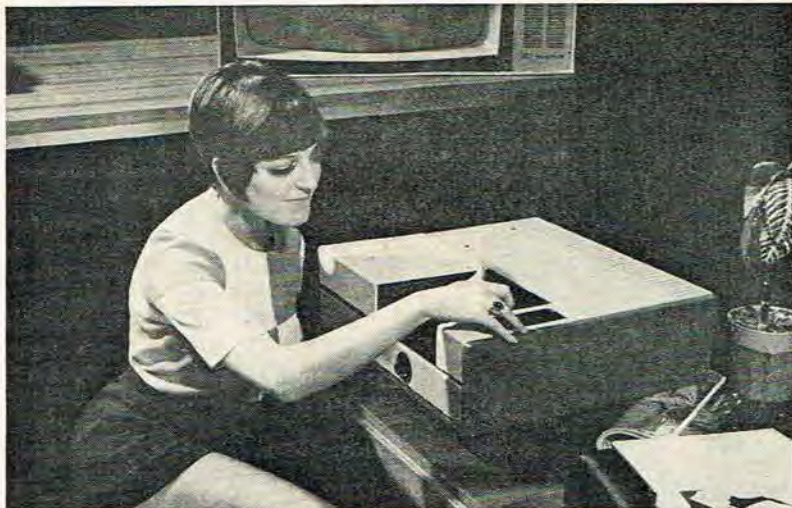
Ordet TV-kassetter dækker fire-fem metoder til at konservere billeder og lyd. Billedet herover viser apparaturet til det britisk-amerikanske EVR-system, der arbejder med fotografisk film.
