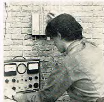
Hjertet i antenneanlægget, som formidler HF-energi til flere hundrede familier, er forstærkeren, som her slutprøves af en specialist fra sønderjyske »Arcodon«.
