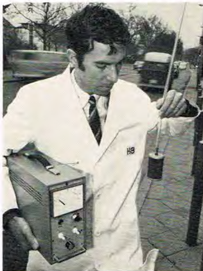
Sorgelig aktuel elektronik: Harmann & Brauns sonde og indicator for test af luftforurening.
