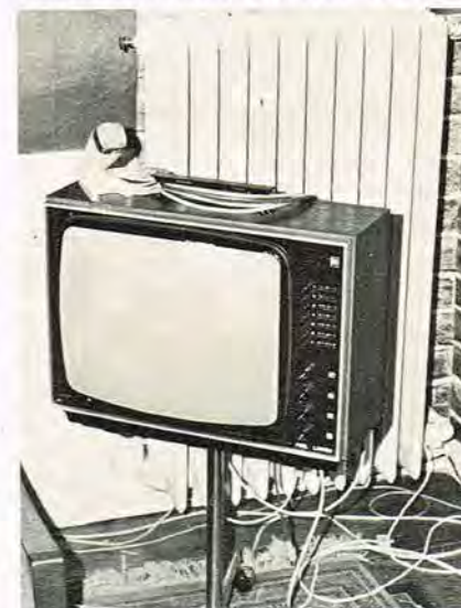
Her ses B & O's monitor Beovision 500, hvor der i bag er indbygget en video-ind- og udgang. Som mikrofon benytter Poul Larsen en Sennheiser MD 21 med kugle-karakteristik.
