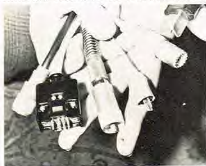
En håndfuld kabelstik som skal til, for at man kan «lege» med videoudstyr. Fra venstre, kamera-TV-monitorkabel, 8-pole monitor-videobåndopt. kabel, coaxstik, HT-stik, Kamerakabel, og antennefladstik.
