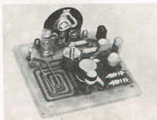
En lille fiks sender (FM) der kan arbejde fra 60—146 MHz. Kan også anvendes som målesender. HUSK P&T BESTEMELSERNE. Som kit kr. 35,25
