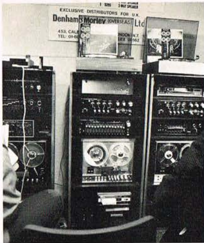
Så meget udstyr skal der til for at demonstrere 4-kanals stereo. Apparatet i midten med de mange knapper er en tonereguleringsenhed, der deler frekvensområdet op i 7 (!) bånd for at opnå bedst mulig tilpasning til lytterummet.
