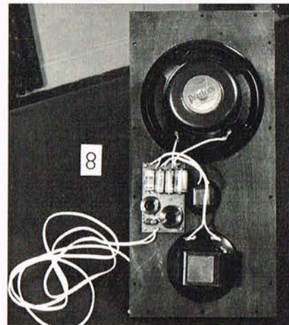
TIL VENSTRE fig. 2, der viser, hvordan frontpladen fremstilles. HEROVER fig. 8, som illustrerer forbindelsen af højttalere og delefilter.
