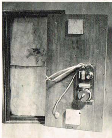
kiggede ind i kabinettet. Delefilteret er monteret på bagpladen og man ser dæmpningsmateriale.
