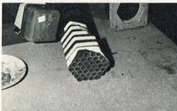
Den »sekskantede« mikrofon set fra bagsiden. Til venstre er kassen til højttaleren, og til højre er denne i kassen.
