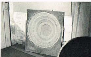
Her skabelonen til parabolen udført i spånplade med dimensionen 22 mm.
