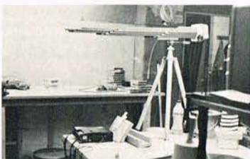
Rørmikrofonen i al sin enkelhed. På kassen til venstre kan man skimte udtaget til forstærkeren. Der er benyttet et almindeligt DIN-stik.
