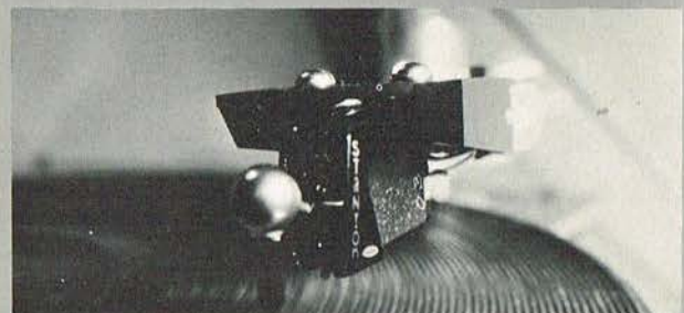
Stanton 681 EE monteret i en 10" Transcripator arm.
