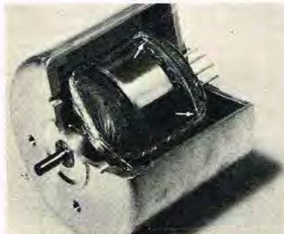
Nyheden i båndoptagere — Hall-motoren, som giver en konstant gang, og som let styres af flip-flop kredse.
