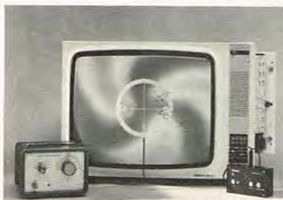
Spole for indstilling af farverenhed ved CTV-modtagere. En spole tilsl. en spec. generator.
