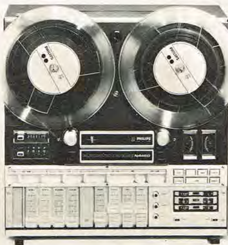
Den nederste halvdel er beslaglagt af reguleringsgreb for hele elektronikken. Helt forinden de 8 skydereulatorer og over dem de vandretgående omskiftergreb.
