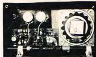
Her et blik ind i modtageren. Forneden ferritstaven, foroven potentiometrene (den står på hovedet).
