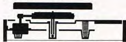
Stilletisk tegning af den mekaniske opbygning med synkronmotoren i venstre side.
