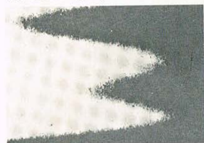
Et udsnit af optisk lyd forstørret ca. 250 gange. Man ser tydeligt filmens enkelte korn, og disse forårsager sus og støj ved gengivelsen.
