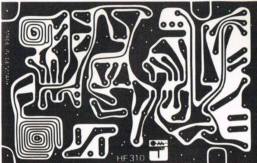
Fig. 5. Printpladen med de »trykte« HF-spoler til HF-indgangstrin og oscillator.
