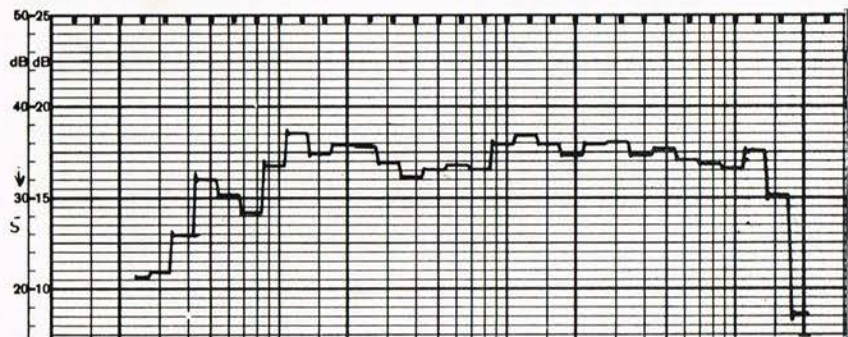
Fig. 3. Måling i lyd dødt rum af en Philips højttaler type RH 22 RH 405. Frekvensgangen viser ikke store udsving og gengivelsen er behagelig i gennemsnits dagligstuer.
