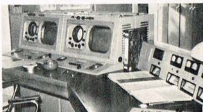
Udsnit af TV-kontrolpulten. Monitoren t.v. viser indkommet signal, oftest hentet fra Kiel, t. h. monitor for udsendt signal.
