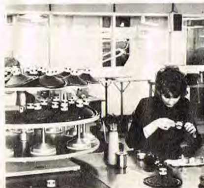
PE-redaktør Knud Søndergaard inspicerer samlebåndet på Scan-Speak . Nederst: Sådan foregik monteringen af membranerne.
