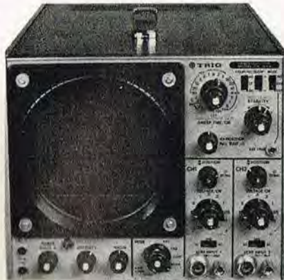
Fig. 4. Japansk Trio/Kenwood oscilloskop, led i en serie fortræffeligt måleudstyr.
