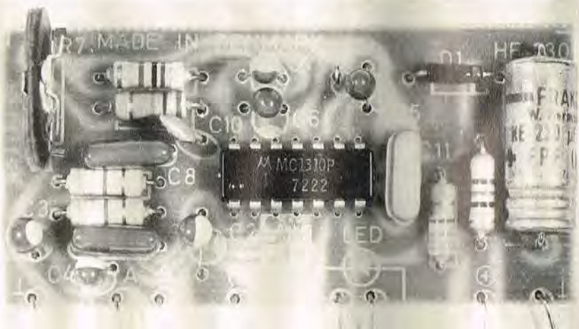
Foto af den færdigmonterede stereo-dekoder, der ikke er en skrivebordskonstruktion, men et helt nyt, gennemtestet byggesæt fra Josty KIT. PE-læserne må efterbygge til eget brug.
