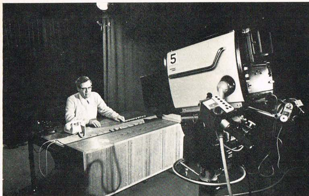
Til sidst, men ikke mindst, viser vi husets fjernstyrede TV-kamera, som bruges i stor udstrækning af TV A. Kommenteringen tager programsekretær Sigfred Jespersen sig af. — TV-studiet råder endvidere over en såkaldt »pilotvogn«, en transportvogn med film- og lyd-grej samt et TV-kamera, der styres af en tontenerator.
