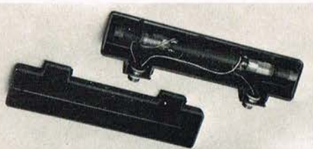
Ferrit-antennen i hus. Vi har taget dækslet af »foderalet« og ser selve antenestaven med tilslutningerne ført til 5-polede DIN-stik.
