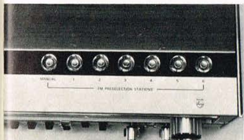
»Easy Touch« knapperne. En let berøring, og der skabes en overgangsmodstand mellem centerpladen og den ydre ring — en tyristor »switcher«, der sendes spænding på en afstemningsdiode samtidig med en lysindikering under en gennemsigtig kunststoffring.
