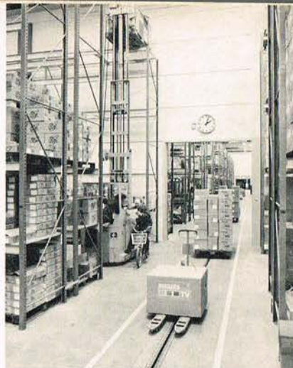
En kæde i gulvet mellem to skinner kan hver sjette meter transportere løftevognene rundt i hallerne — hvor man i øvrigt må bruge cykel.
