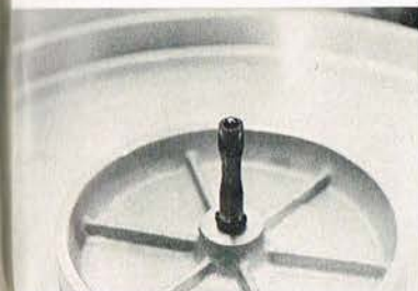
Pladetalerkenens aksel — bemærk, at den er afdrejet på midten.
