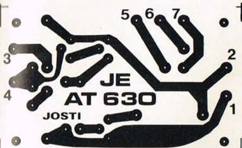
Printtegningen for automatikkredsløbet.
