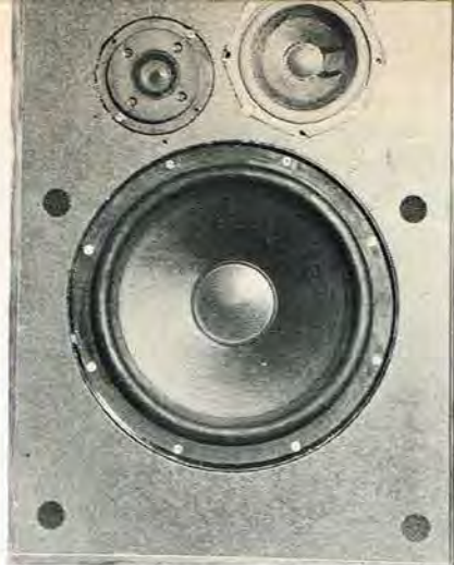
Udsnit af frontpladen. Enhederne både boltet og limet fast — kabinettet 100 pct. lufttæt.
