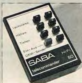
Fjernstyringsenheden »telecommander« med de 8 trykknapper til forskellige styringsfunktioner. Funktionsrejeknapperne med lysindikatorerne nedenunder.
