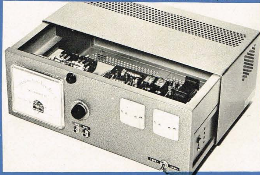
Komplet temperaturstyringsanlæg, der både aktiveres for stigende og faldende temperatur.
