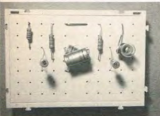
Astabil multivibrator — blinker — opbygget på S-DeC.
