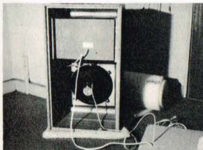
Et eksempel fra udviklingsstadiet — først gik man ud fra, at lydholderne skulle være cirkelrunde — senere afløst af gælleformede.
