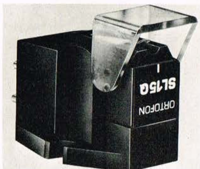
Ortofon's nye quadrophoni pick-up, med beskyttelsesbøjlen slået ned.
