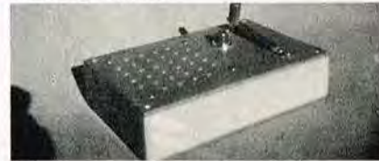
Morsetræner indbygget i acrylkabinettet med batteri og højtaler.
