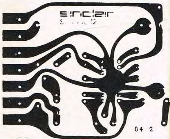
Fig. 1. IC 12'eren kan levere 6 watt i 4 Ohm ved en forsyningsspænding på maximal 15 volt eller 6 watt i 8 Ohm ved 20 volt. (Strømforsyning NT315).
