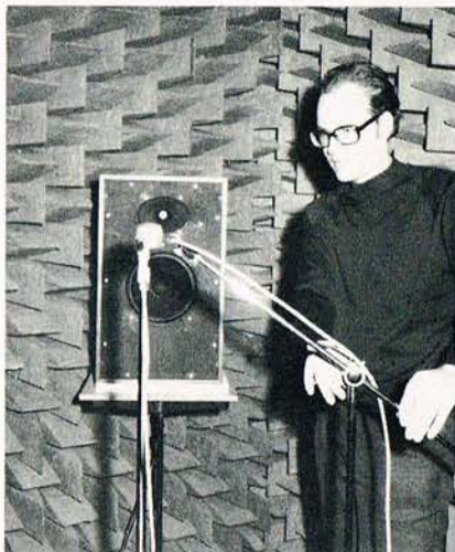
Ingeniør Torben Krogh er i det lyddøde rum hos KINOVOX ved at indstille målemikrofonen, der ved siden af en af mikrofonerne, der skal testes, er placeret 1 m fra højttaleren.
