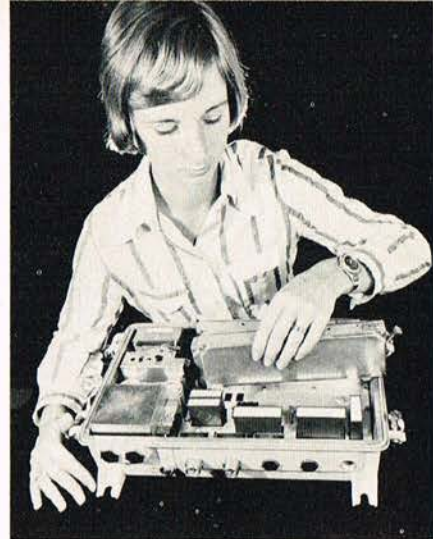
Moderne antenneforstærkere til byanlæg er opbygget med moduler, så installationen kan udføres harmonisk og stabilt. Fotoet viser en Siemens-forstærker, beregnet for 15 aktive og 17 passive modultyper, der skaber tilpasning i anlæggets struktur.
