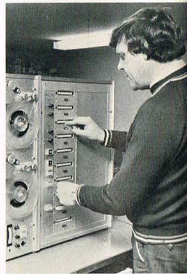
Kapelmester Ole Erling ved det nye kopieringsanlæg, der er leveret af LYREC. Der kopieres med 8x normal hastighed til kassettekolonner på hver 10 stk.
