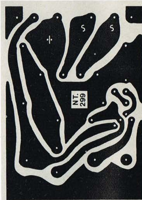
Printtegningen for netdelen. Kan eventuelt afkortes, såfremt serietransistoren ikke benyttes, der skæres efter en linie svarende til den punkterede på monteringsplanen.
