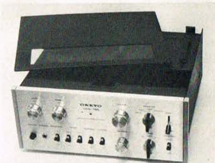
Samtlige tilslutninger – med undtagelse af bøsningen for stereohovedtelefonen – er placeret i en fordybning på forstærkerens overdel, dækket af et låg med en plexiglasrude – her er låget fjernet lidt.
