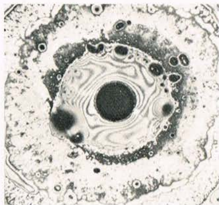
Bliver et ur rensat med ultralyd, er resultatet som billederne viser. De ser sekundhjulene — stenhjul før og efter påvirkningen — urenheder er som blæst bort og uret vil sandsynligvis kunne gå igen.
