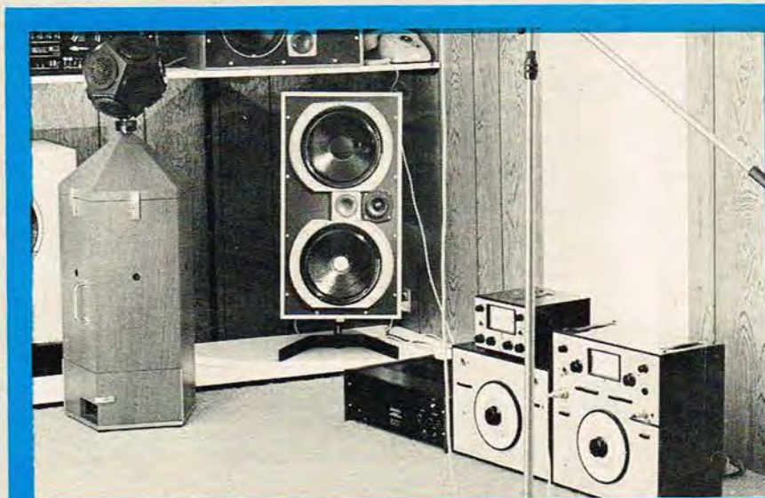
»Det ideelle lytterum« under kontrolmåling ved hjælp af B&K-måleudstyr til ca. 250.000 kr. På gulvet en isotropisk højttaler, drevet af en Galatron effektforstærker, som modtager impulserne fra den »lille« impuls-generator, der ses ovenpå terz-filtret. På mikrofonstativet er monteret en 1/2" kondensermikrofon med forforstærker. Signalet modtages af rørvoltmetret med indbyggede filtre og sendes retur til impuls-generatoren, der ved en digital sammenligningsproces udlæser efterklangstiden i brøkdeler af sekunder.
