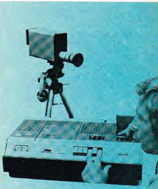
PHILIPS »VCR-System« består af en recorder N1500 med indbygget tv-del og tænd/sluk ur. Signalet kan overføres til en alm. tv-modtager. Båndkassetten måler 13×15×3,5 cm og indeholder et 1/2" bånd med længder op til 60 minutter. Båndhastigheden er 14,29 cm/s.
