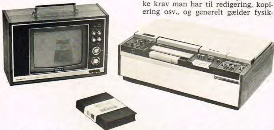
SONY's »Umatic Video System« består af en recorder som her vist, eller en afspiller, og en monitor. Båndkassetten måler 22×14×3 cm og indeholder et 3/4" bånd med længder op til 60 minutter. Båndhastigheden er 9,5 cm/s.
