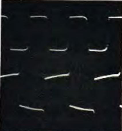
Oscillogrammer af tilførte frekvenssignaler ved indgang AUX med et niveau svarende til -6 dB under fuld udstyring for frekvenserne 100 Hz (øverst) og 5 kHz (nederst).
