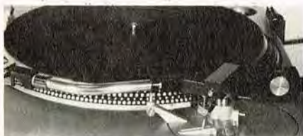
Pladespilleren SL 1200. Læg mærke til stroboskopringene i kanten af pladetallerkenen.
